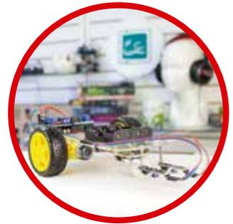
Nuestro seguidor de línea es sencillo de armar y programar. Para probarlo, sólo traza una línea con marcador negro o cinta de aislar y tu seguidor recorrerá la ruta trazada.
